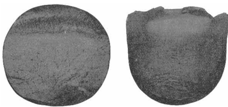
Abb. 13. Links: Rohbruch eines geglühten Martinstahls; rechts: Rohbruch eines vergüteten 5%igen Nickelstahls. (Die Stücke hatten in Wirklichkeit einen Durchmesser von 200 mm.)
