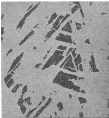
Abb. 8. Feingefüge von ungeglühtem Stahlguß. 50 ×
