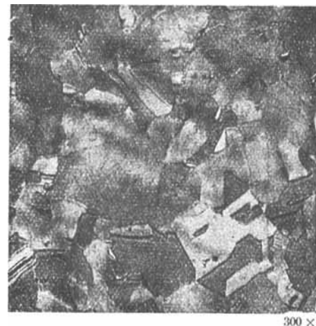
Abb. 4. Austenitisches Gefüge eines geglähten 25%igen Nickelstahls.
