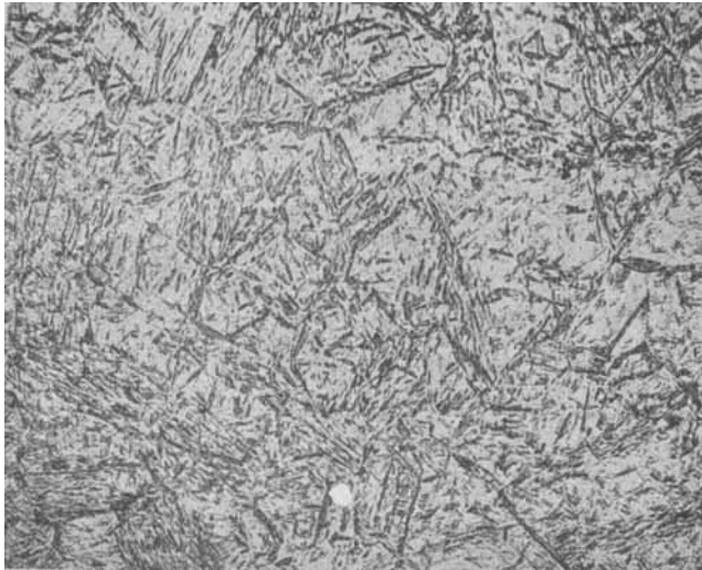
Abb. 5. Martensit der Randzone eines in Wasser gehärteten Kohlenstoffstahls. 300 ×
